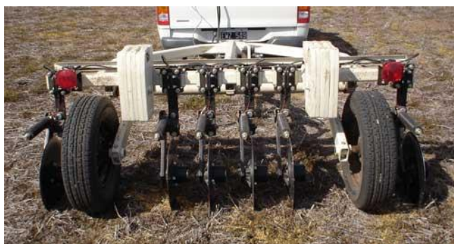
Рисунок 9.3 – Измерение электропроводности почвы с помощью прицепной машины Veris 3100 (компания Veris Technologies, США)
